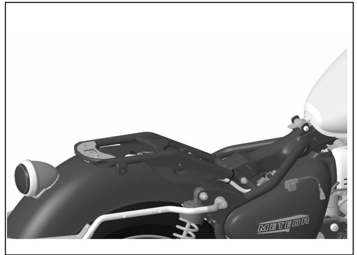
**23** Lösen Sie die Befestigungen des hinteren (1) und des vorderen (2) Schutzblechs.
