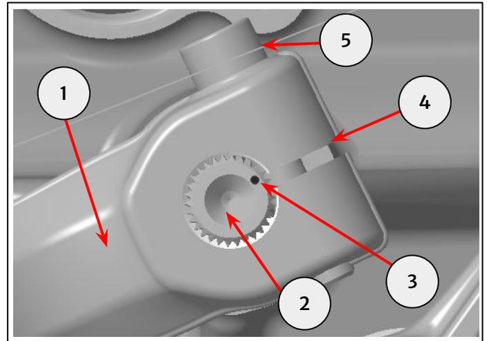
**3** Coloque la puntera (1) en la posicion deseada dentro del intervalo de ajuste. Apriete la fijacion (2) a **8 Nm**.
