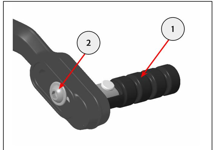
**Nota:** Los pasadores de pivote de la puntera plegable deben lubricarse junto con el pivote del pedal del freno trasero en el intervalo indicado en el Manual del propietario. Los pasadores no deben retirarse.
