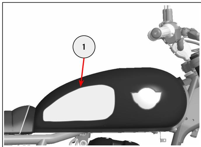
**3** Prendere il paraserbatoio sinistro (1, notare la presenza di una "L" sulla plastica rossa del paraserbatoio sinistro) e rimuovere la pellicola. Allineare con cura il paraserbatoio, sfalsato di 22 mm dal raggio del serbatoio (2) e di 24 mm dal bordo inferiore del serbatoio (3). Il paraserbatoio deve essere completamente inserito nell'incavo del serbatoio.
