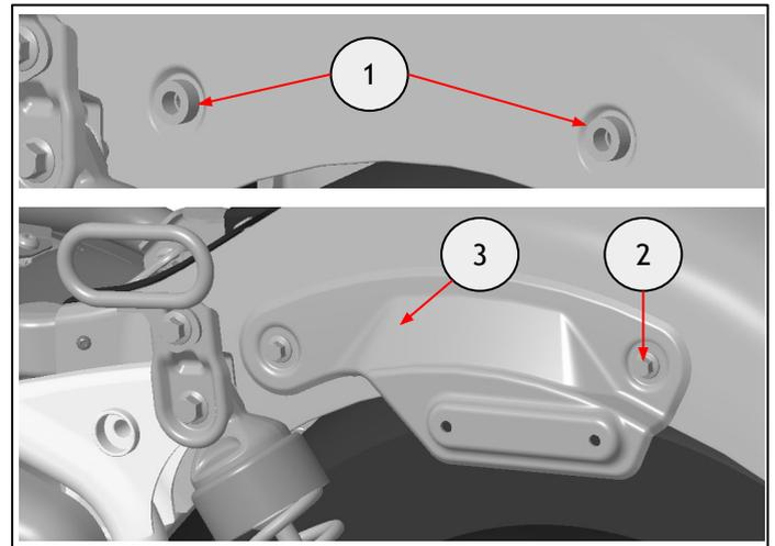
**7** Coloque el separador (1) de 23 x 24 mm del kit en el casquillo del bastidor. Coloque la fijación M8 x 70 mm (2) del kit con una tuerca M8 (3) del kit para fijar el soporte superior del riel de la alforja izquierda (4).
