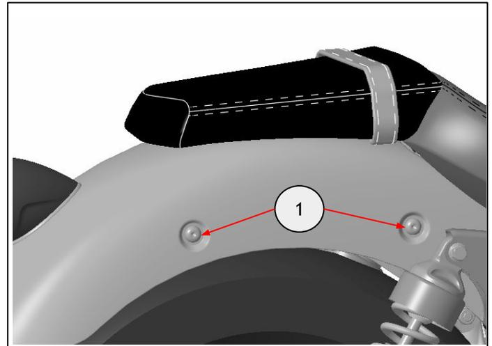
**6** Alinee los separadores de 20 x 8mm (1) del kit con los orificios de montaje. Coloque las fijaciones M8 x 25 mm (2) del kit para fijar el soporte izquierdo (3). Apriete las fijaciones a **30 Nm**. Repita el paso 6 en el lado derecho.
