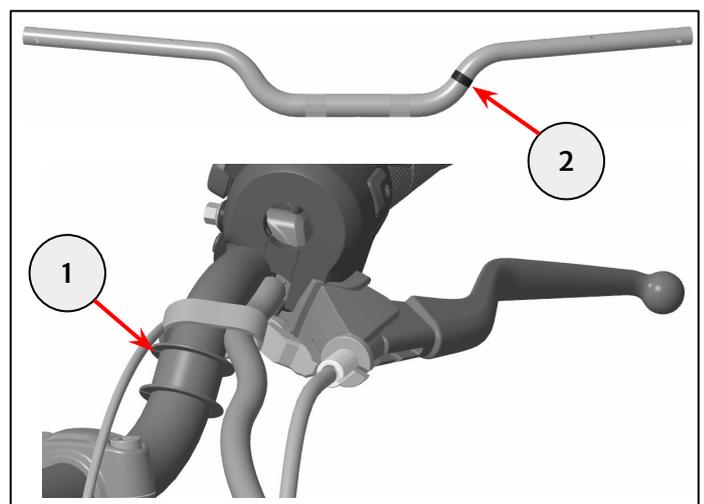
**5** Montieren Sie den Handprotector (1) mit einer Innensechskantbefestigung M6 x 25 mm mit Gewindesicherung (3) im Lenkerende (2) und setzen Sie ihn auf die Gummimanschette (4). Ziehen Sie die Befestigung zu diesem Zeitpunkt nicht vollständig fest.
