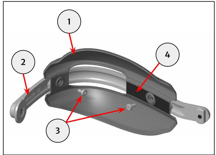
**2** Bringen Sie die linke Halterung (1) mit einer Halbrundkopfbefestigung M6 x 25 mm (3) an der Querstrebe (2) an.
