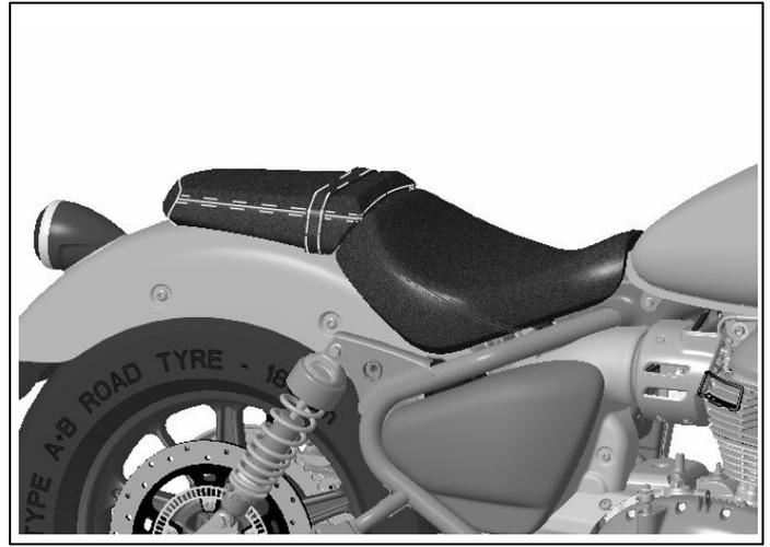
**2** Retire los soportes del sillín del pasajero (1) retirando las fijaciones (2). Guarde los soportes y las fijaciones para volver a utilizarlos si la motocicleta se va a volver a dejar en su estado original.
