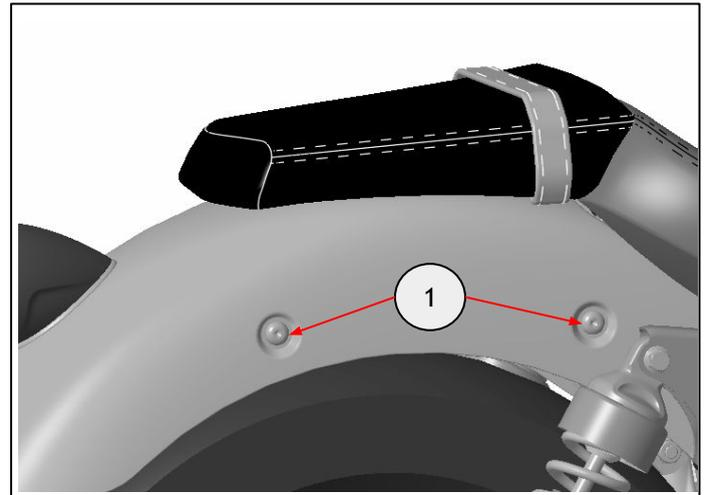
**6** Richten Sie die Abstandhalter 20x8 mm (1) aus dem Teilesatz auf die Befestigungslöcher aus. Montieren Sie die Befestigungen M8 x 25 mm (2) aus dem Teilesatz, um die linke Halterung (3) zu befestigen. Ziehen Sie die Befestigungen auf **30 Nm** an. Wiederholen Sie Schritt 6 auf der rechten Seite.
