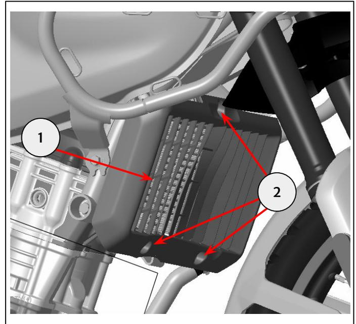
**2** Bringen Sie das obere Ende des neuen Kühlerschutzes (2) mit der Befestigung M6 x 14 mm (1) aus dem Montagesatz am oberen Ende des Kühlers (3) an. Zu diesem Zeitpunkt nicht vollständig festziehen.
