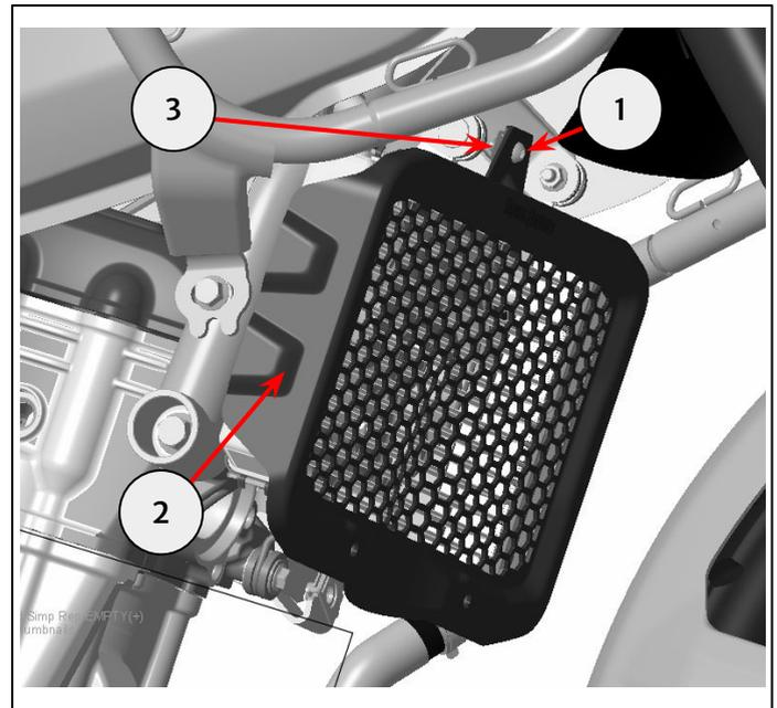
**3** Setzen Sie einen Abstandhalter (1) aus dem Montagesatz zwischen den Kühlerschutz (2) und den Befestigungspunkt (3) am Motorrad. Setzen Sie die Befestigung M6 x 35 mm (4) durch Kühler und Abstandhalter hindurch ein. Zu diesem Zeitpunkt nicht vollständig festziehen. Für den übrigen Abstandhalter und die übrige Befestigung wiederholen.
