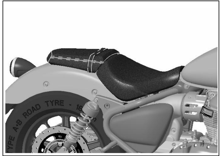
**2** Entfernen Sie die Befestigungen (2) und bauen Sie die Beifahrersitzhalterungen (1) aus. Bewahren Sie Halterungen und Befestigungen für den Fall auf, dass das Motorrad wieder in seinen ursprünglichen Zustand versetzt werden soll.
