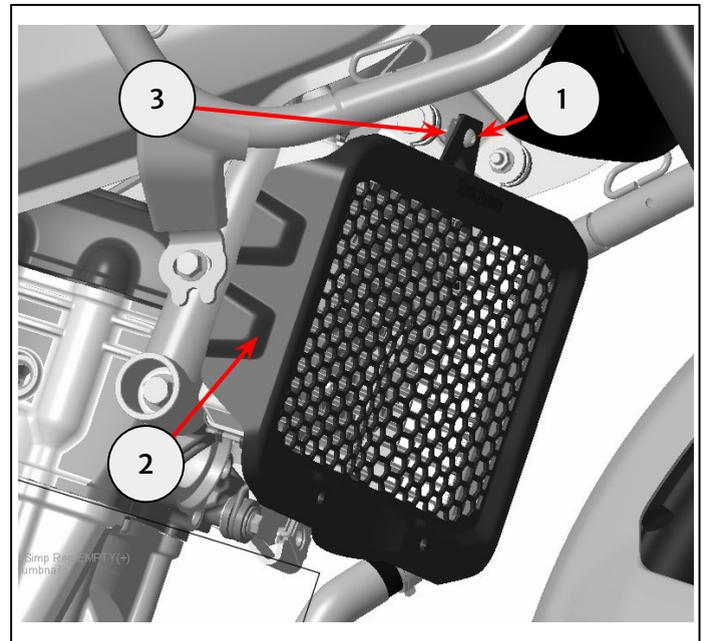
**3** Posizionare un distanziale fornito nel kit (1) tra la protezione del radiatore (2) e il punto di montaggio della motocicletta (3). Inserire la vite M6 x 35 mm (4) attraverso il radiatore e il distanziale. Non serrare completamente in questa fase. Ripetere per l'altro distanziale e l'altra vite.
