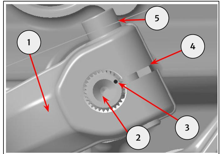
**3** Posizionare il puntale (1) nella posizione desiderata all'interno dell'intervallo di regolazione. Serrare la vite (2) a 8 Nm.
