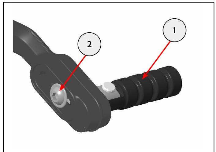
**Nota:** I perni girevoli del puntale pieghevole devono essere lubrificati insieme al perno del pedale del freno posteriore secondo l'intervallo indicato nel Manuale del proprietario. I perni non devono essere rimossi.
