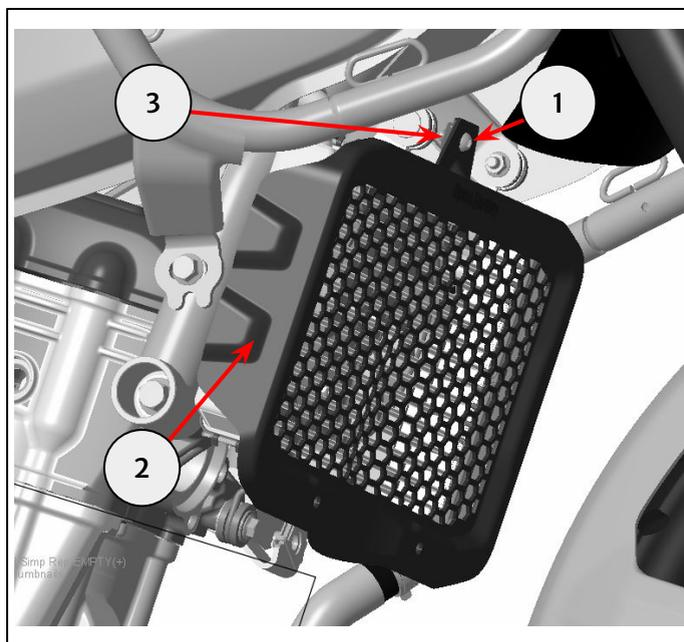
**3** Posez une entretoise provenant du kit (1) entre la protection de radiateur (2) et le point de montage sur la moto (3). Posez la fixation M6 x 35 mm (4) au travers du radiateur et de l'entretoise. Ne serrez pas complètement à ce stade. Répétez l'opération pour l'autre entretoise et la fixation associée.
