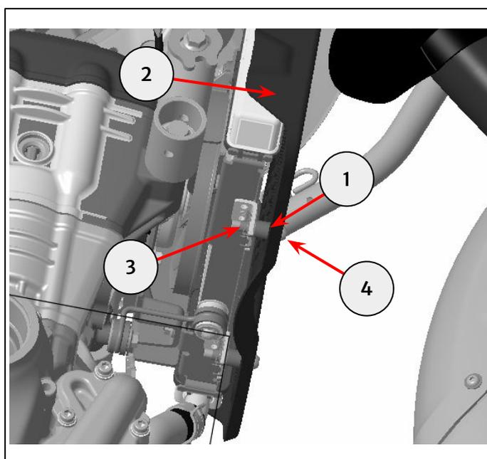
**4** Serrez les fixations inférieures (1) à **10 Nm**. Serrez la fixation supérieure (2) à **10 Nm**.
