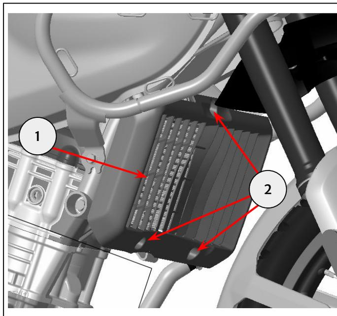
**2** Avec la fixation M6 x 14 mm provenant du kit (1), fixer le dessus de la protection de radiateur neuve (2) sur le dessus du radiateur (3). Ne serrez pas complètement à ce stade.
